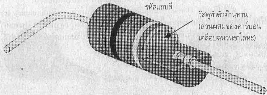
รูปที่ 6.5 โครงสร้างภายในของตัวต้านทานแบบคาร์บอน ซึ่งเป็นค่าความต้านทานแบบค่าตายตัว
