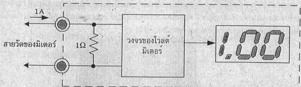
รูปที่ 7.21 การใช้กระแสเพื่ออ่านค่าในมิเตอร์แบบดิจิทัล (Richard J. Fowler. 1992 : 322)
